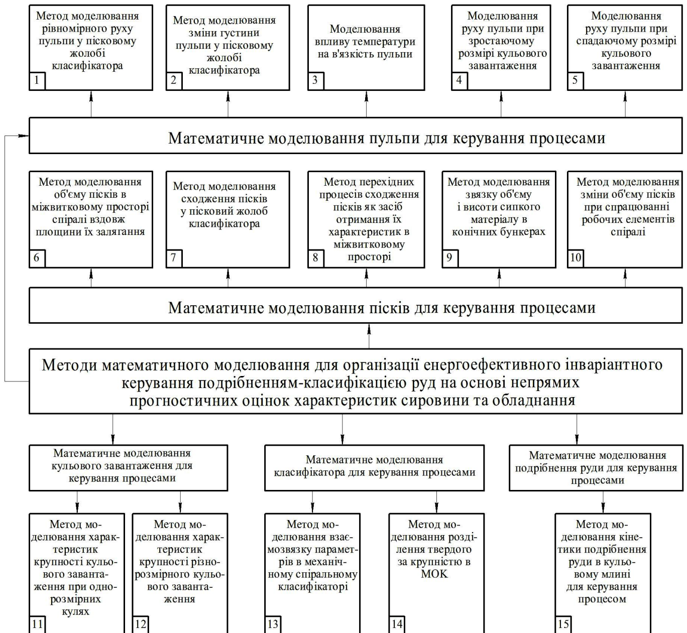
Рис.2. Методи математичного моделювання, які слід застосувати в процесі розробки енергоефективного інваріантного керування подрібненням-класифікацією руд на основі непрямих прогностичних оцінок характеристик сировини та обладнання
